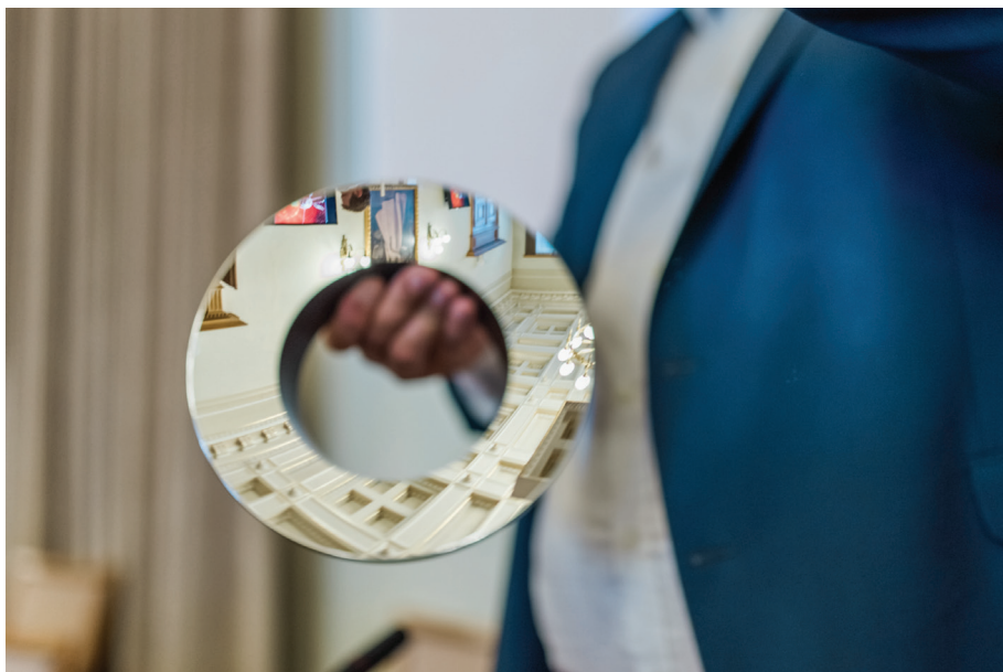
Obr. 1.3 Zrcadla M1 a M2 ve tvaru mezikruží (zdroj: TOPTEC)
