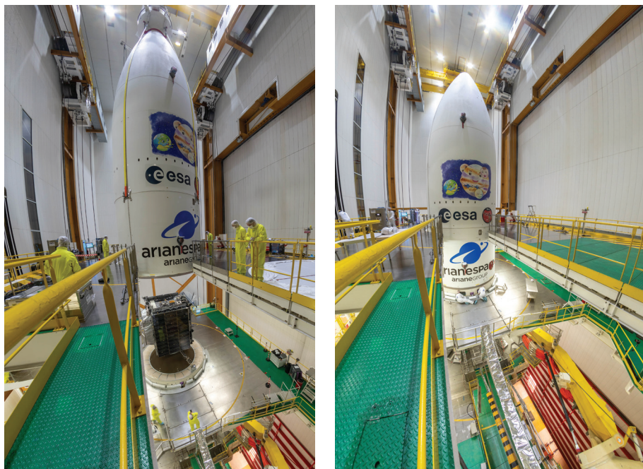
Obr. 2.2 Zakrývání sondy JUICE upevněné na špičce nosné rakety Ariane 5 aerodynamickým krytem se uskutečnilo 4. dubna v montážní budově BAF (Bâtiment d'Assemblage Final) na kosmodromu Kourou ve Francouzské Guyaně (zdroj: ESA)
