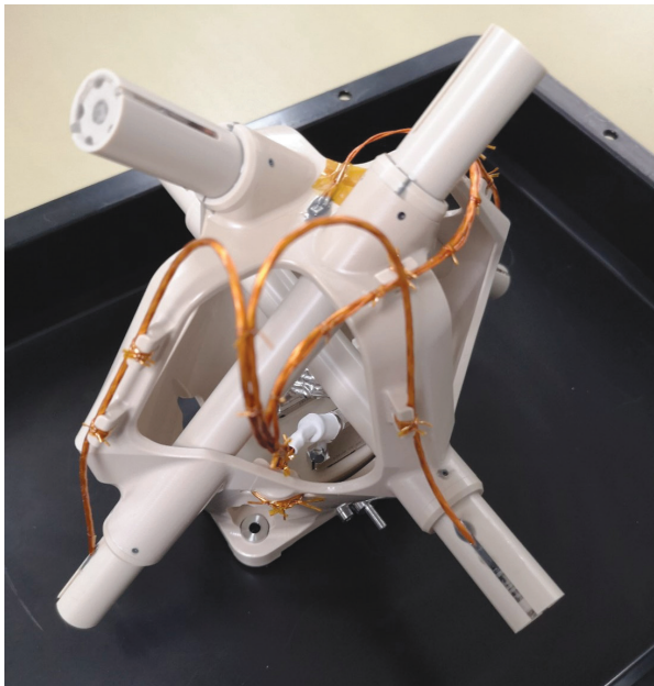
Obr. 2.7 Tříosý cívkový magnetometr pro sondu JUICE postavený v Laboratoři plazmatické fyziky École polytechnique v Paříži poskytuje vstupní signál pro náš analyzátor (zdroj: LPP)
