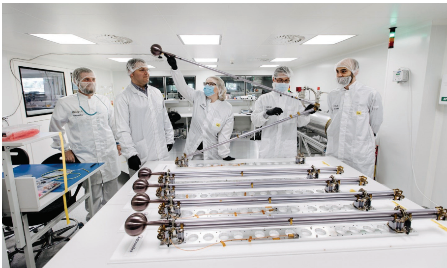
Obr. 2.8 Ramena s elektrickými čidly postavená polským podnikem Astronika jsou také připojena na vstup našeho analyzátoru (zdroj: ASU AV ČR, ÚFA AV ČR)
