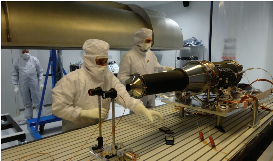
Obr. 1.5 Celkový pohled na koronograf Metis během laboratorních testů (zdroj: Konsorcium Metis)
