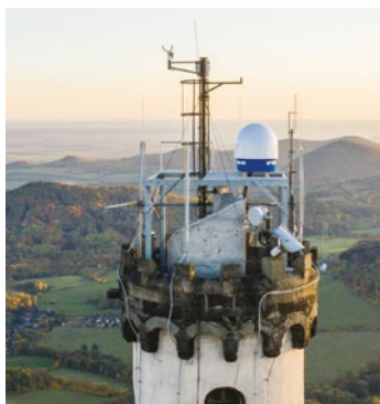
Obr. 5 Polarimetrický dopplerovský radar FURUNO umístěný na věži observatoře a příklad jeho měření z 10. července 2024 v 14:20 UTC (radarová odrazivost v dBZ ve vertikálním řezu ve směru od Milešovky přibližně na východ; radar je v bodě 0, černé čtverce označují místa elektrických výbojů odvozená z měření bleskoměrné sítě ENTNL)
